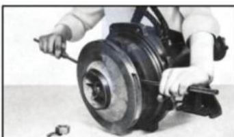
شکل ۱۳: خارج کردن پروانه
