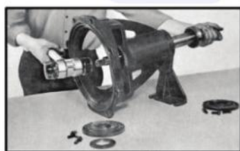
شکل ۱۷: خارج کردن محور
