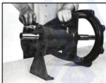
شکل ۱۶: خارج کردن درپوش یاتاقان
