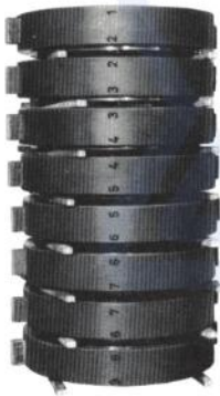
شکل ۱۵: شماره‌بندی و قرار دادن طبقات به ترتیب روی هم
