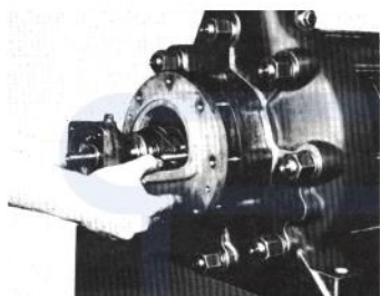
شکل ۱۰: خارج کردن پایه یاتاقان به همراه رولبرینگ
